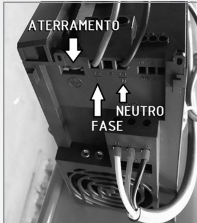
Layout elétrico do inversor para ligação monofásica
